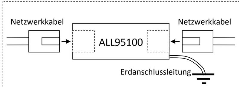
*Anmerkung: Durch den bidirektionalen Aufbau des ALL95100 Surge Arresters ist der Ein- und Ausgangsseitige Anschluss beliebig tauschbar.*
