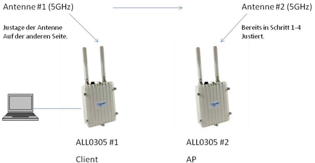
5. ALL0305#1 wird jetzt als Client(WDS) konfiguriert. ALL0305 #2 wird als AP(WDS) konfiguriert. Am ALL0305 #1 wird der PC per Ethernetkabel angeschlossen.
