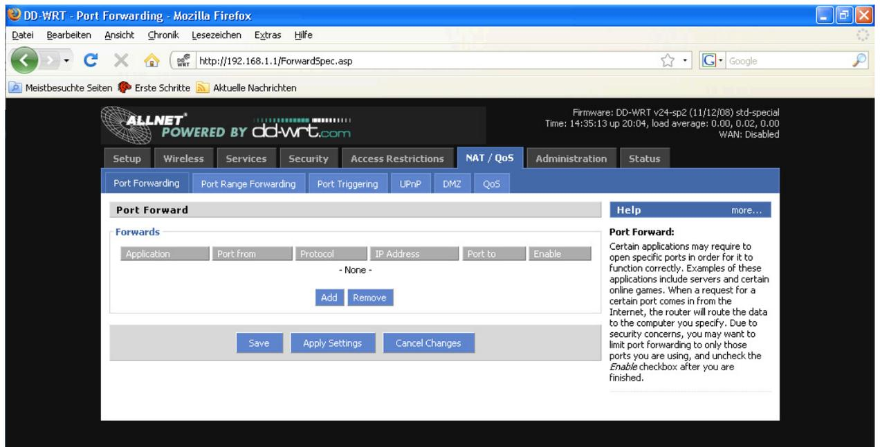
Vor dem Hinzufügen oder dem Entfernen eines neuen Portforwards sollten geänderte Einstellungen gespeichert werden, da die Eingabemaske bei diesen Vorgängen neu geladen werden und nicht gespeicherte Eingaben verloren gehen.
