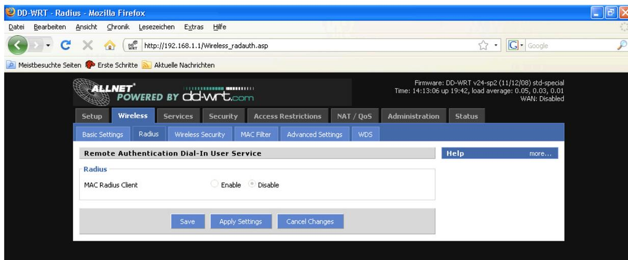
Mit Hilfe dieser Funktion können WLAN-Benutzer gegen einen Radius-Server authentifiziert werden. Dies ist nur im AP-Modus möglich.
