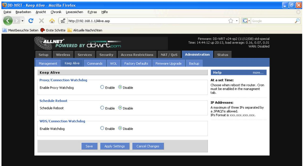
Die Keep-Alive Funktionalität ermöglicht es, verschiedene Überwachungsmethoden zu aktivieren, die bei einer möglichen Funktionsstörung das System neu starten.
