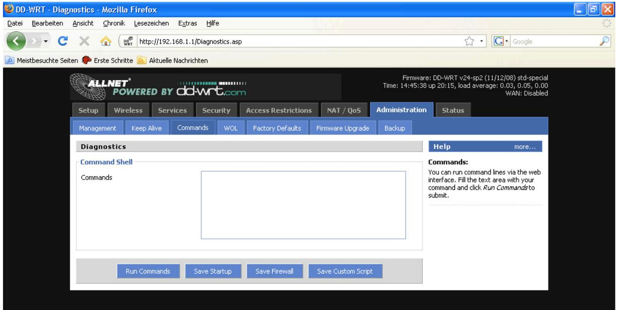
Neben dem direkten Ausführen von Shell-Kommandos können auch Startskripte und Firewall-Skripte hinterlegt werden, das Speichern eigener Shell-Skripte ist ebenfalls möglich.
