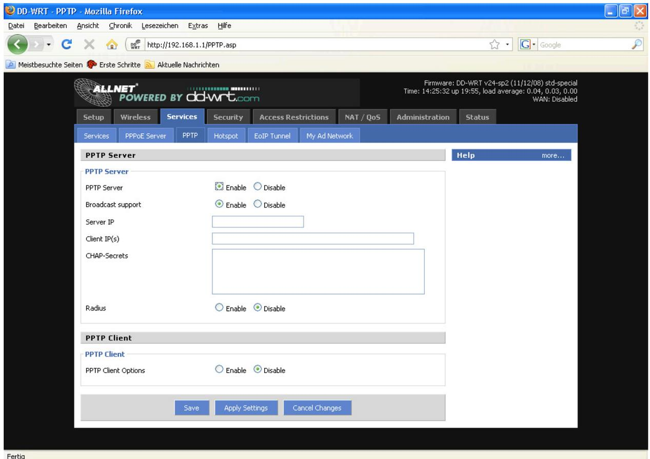
Bei der Angabe des IP-Bereichs sollten Überschneidungen mit dem DHCP-Bereich (sofern DHCP aktiviert wurde) vermieden werden. Der IP-Bereich der Clients wird mit folgender Syntax eingegeben:
