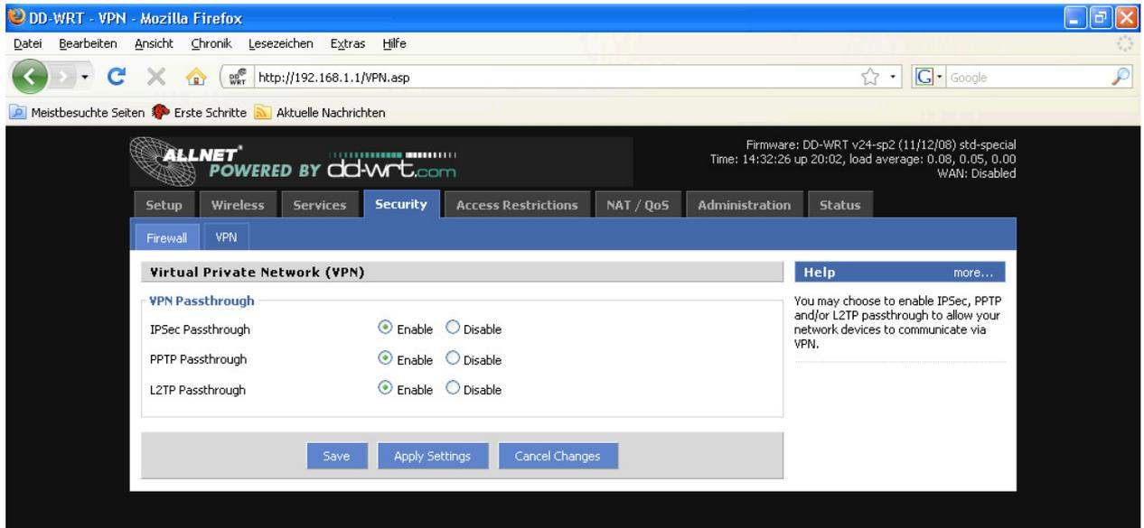
Im VPN-Tab wird das Firewall-Handling von IPSec, PPTP und L2TP-Verbindungen definiert. Standardmäßig ist Passthrough eingestellt.
