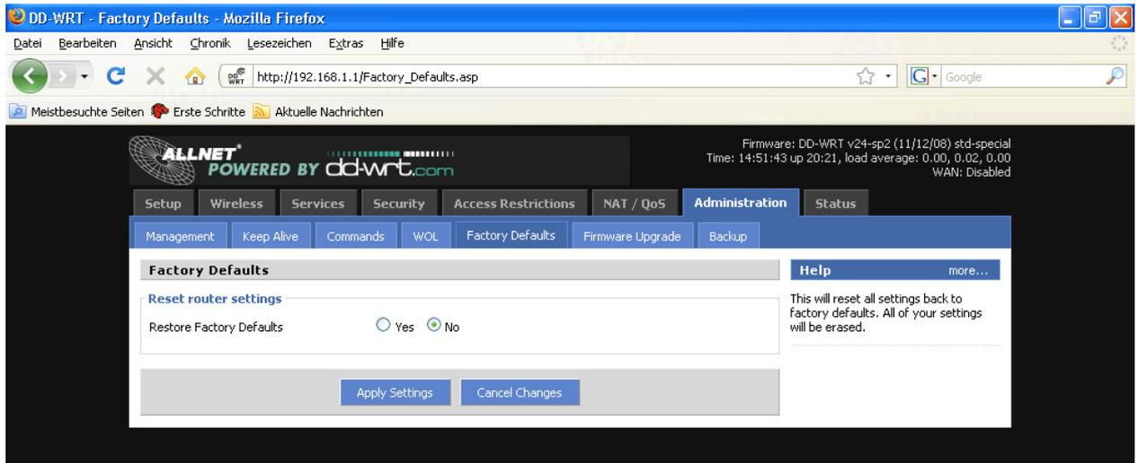
Über diese Funktion kann der Router auf die Auslieferungseinstellungen zurückgesetzt werden. Der Router führt nach dem Zurücksetzen einen Neustart durch.
