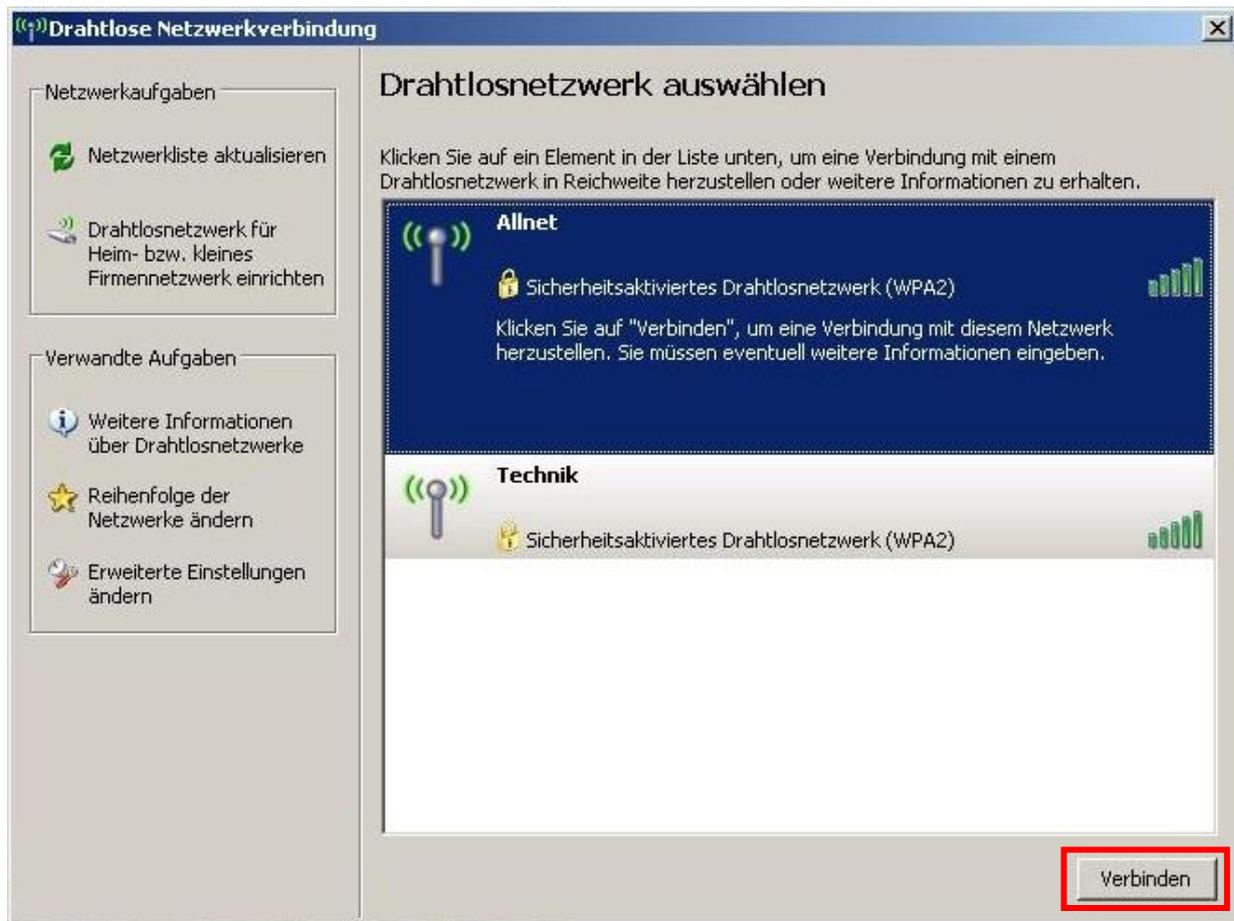
6. Sie werden in folgendem Fenster aufgefordert Ihren Netzwerkschlüssel einzugeben. Geben Sie den Schlüssel zur Bestätigung ein zweites Mal ein und mit einem Klick auf „Verbinden“ verbindet sich der ALL0234Nano mit dem ausgewählten Router/Access Point.
