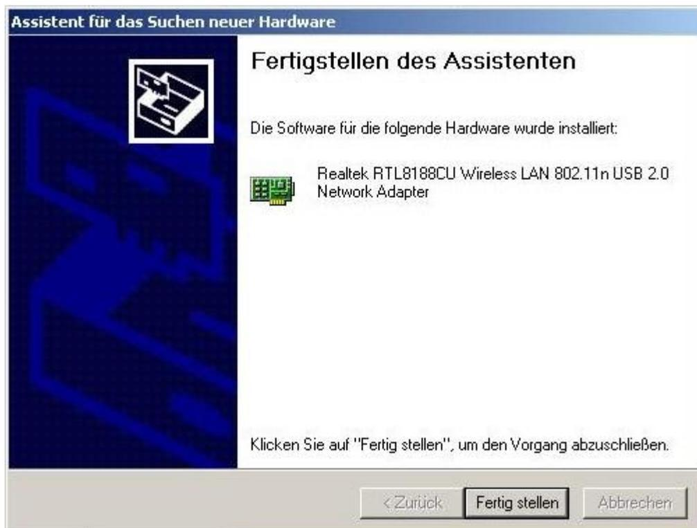
4. Wenn Sie jetzt die *Netzwerkverbindungen* öffnen, finden Sie eine neue **Drahtlose Netzwerkverbindung** (Realtek RTL8188CU Wireless LAN 802.11n USB 2.0 Network Adapter).
