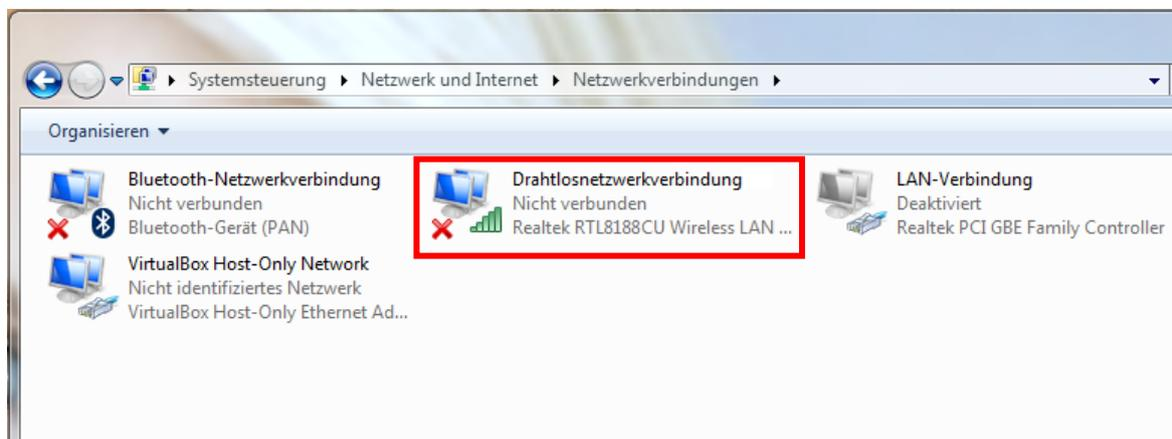
4. Klicken Sie rechts auf diese **Drahtlosnetzwerkverbindung** und wählen „Verbindung herstellen/trennen“ aus. Es öffnet sich folgendes Fenster, indem Sie den gewünschten Router/Access Point auswählen und auf „Verbinden“ klicken.
