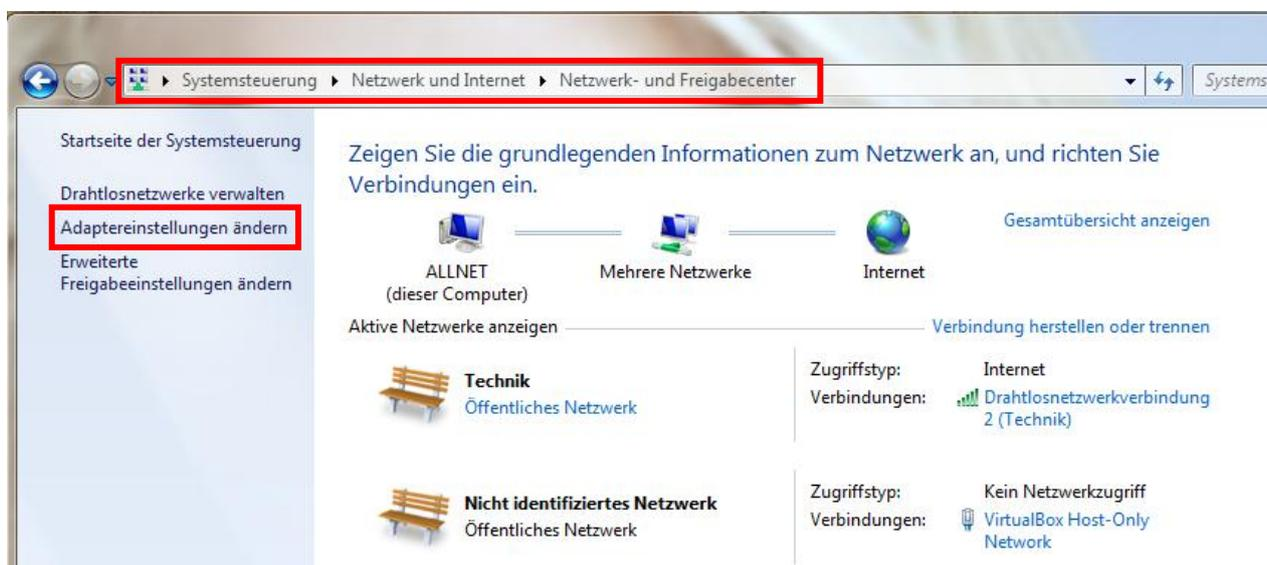
3. Es öffnet sich das Fenster *Netzwerkverbindungen* und hier wird Ihnen die neue **Drahtlosnetzwerkverbindung** (Realtek RTL8188CU Wireless LAN 802.11n USB 2.0 Network Adapter) angezeigt.
