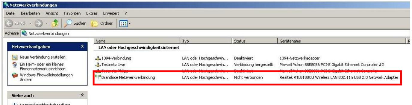
5. Klicken Sie rechts auf diese **Drahtlose Netzwerkverbindung** und wählen „Verfügbare drahtlose Netzwerke anzeigen“ aus. Es öffnet sich folgendes Fenster, indem Sie den gewünschten Router/Access Point auswählen und auf „Verbinden“ klicken.
