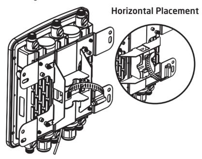
**D)** Bestimmen Sie, wo das Gerät befestigt werden soll. Arretieren und festziehen, um den Masthalter am Mast zu befestigen.
