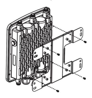
**B)** Bestimmen Sie, welche Bestückung montiert werden soll. Fahren Sie die vier Rundkopfschrauben an, um den Pfostenhalter am Befestigungssockel zu befestigen.
