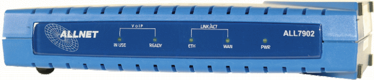
Bild 1: Anzeigen auf der Frontseite des ALL7902
