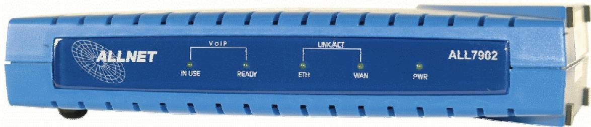
Bild 1: Anzeigen auf der Frontseite des ALL7902
