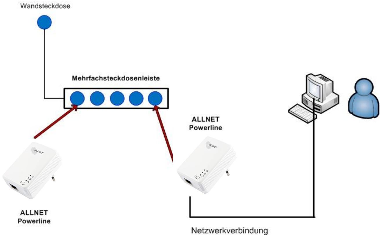
Hinweis: Sollte der Powerlineadapter welcher keine Netzwerkverbindung besitzt anfangen zu blinken, befindet sich diese im Standbymodus. Um den Funktionstest korrekt durchführen zu können müssen Sie den Adapter einfach nur kurz ein und wieder einstecken.
