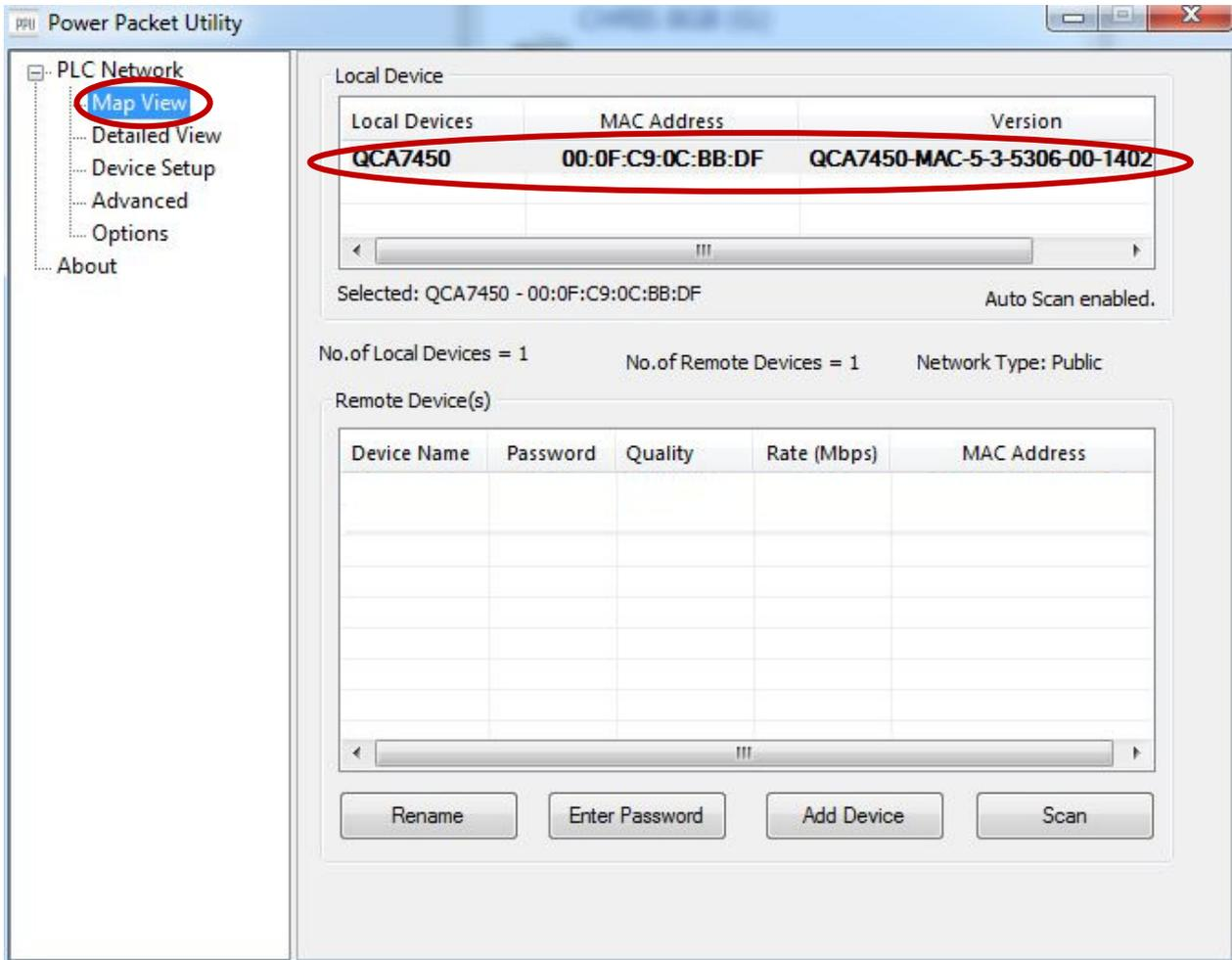
4. Wenn der Adapter erkannt wird können Sie unter dem Menüpunkt **Device Setup** den Network Name (Netzwerkennung) des Adapters bestimmen. Geben Sie dazu einen eigenen Namen oder den Standard-Netzwerknamen „HomeplugAV“ ein und bestätigen Sie mit SET LOCAL DEVICE.
