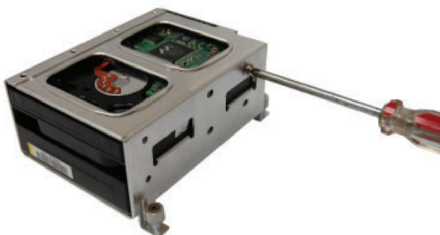
Abbassare delicatamente il supporto del disco di ALL6500.
