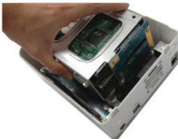
Dopo essersi accertati che il supporto è collocato in modo appropriato e che i connettori sono allineati, fissare il supporto con le viti.
