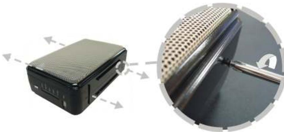
3. Entfernen Sie den oberen Teil des Gehäuses vom Boden.
