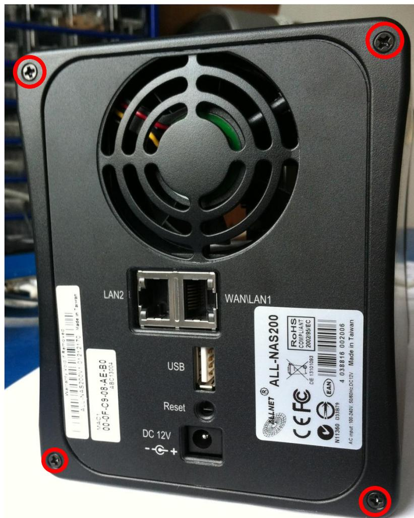
2. Nehmen Sie die schwarze Rückblende ab und lösen Sie anschließend die 4 markierten silbernen Schrauben.
