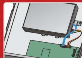
② Schließen Sie das Daten- und Stromkabel an der Hauptplatine an und setzen Sie die Verkleidung auf.
