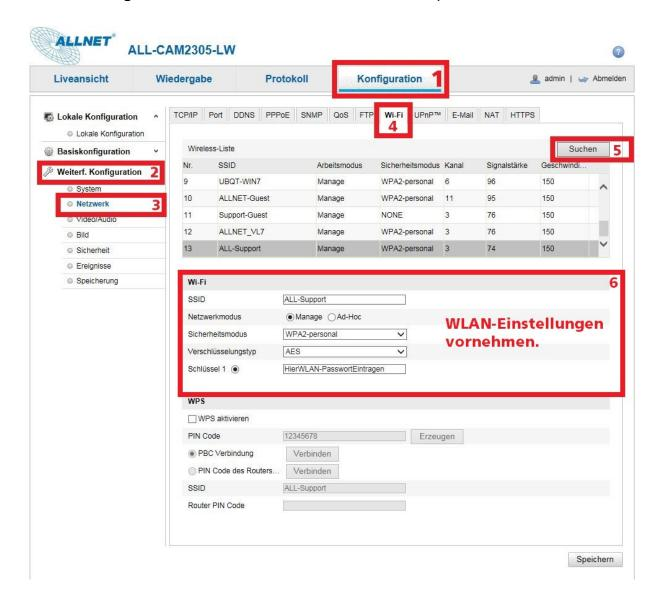
Die Kamera startet neu und bezieht dann eine Adresse per "DHCP". Dies kann in den Netzwerkeinstellungen unter "TCP/IP" geändert werden.
