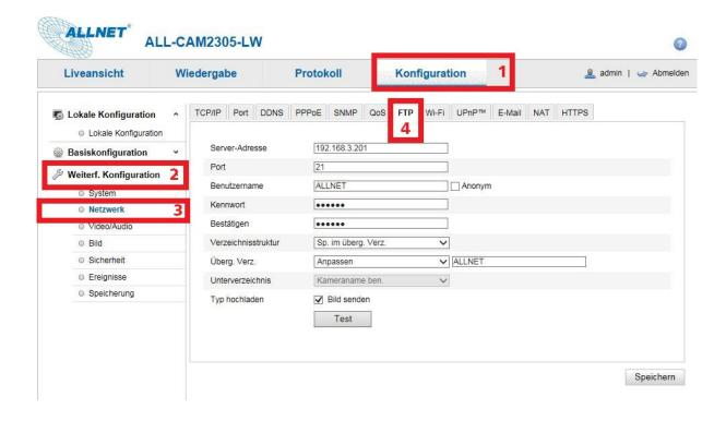
Um die Verbindung nun zu testen, klicken Sie auf die "Test"-Schaltfläche. Nach erfolgreicher Konfiguration, erscheint eine Erfolgsmeldung und ein Bild wird auf dem NAS/FTP-Server abgelegt.
