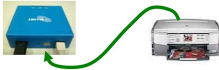
3. Verbinden Sie den ALL0819 mit Ihrem Netzwerk, z.B. Router, Switch. Dem ALL0819 wird automatisch eine IP-Adresse vom Router/DHCP zugewiesen.
