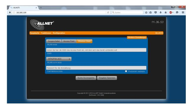
Wählen Sie Wireless Client, um das Gerät mit einem bestehenden Netz zu verbinden. Klicken Sie auf "Suche Accesspoints", um nach Ihrem WLAN-Netz zu suchen.
