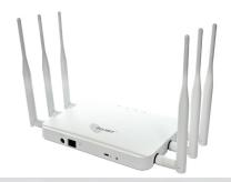
Der ALLNET ALL-WAP02880AC nutzt die Geschwindigkeit und Leistung des IEEE 802.11ac Standards für die Verbindung von Laptops und anderen Geräten, die drahtlose Übertragung von HD-Video benötigen oder große Dateien übertragen müssen.
