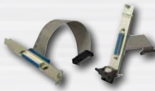
Adapterkabel mit Zusatzslotblech von 20pol. Stiftstecker auf 25polige Sub-D-Buchse ADQ-AP-D25F-cPCI (Art.-Nr. 111755) oder ADQ-AP-D25F-PCIe (Art.-Nr. 111756)
