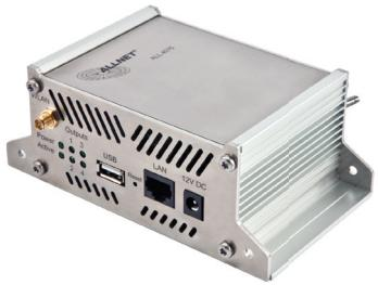
Über das ALLNET ALL4075 4-fach Netzwerk Relais können elektrische Geräte über ein Computernetzwerk geschaltet werden. Die Konfiguration und Bedienung erfolgt unabhängig vom Betriebssystem über einen beliebigen Webbrowser vom PC, MAC, Webpad oder Smartphone. Zusätzliche Software wird nicht benötigt.
