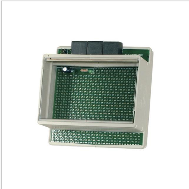
Aus Platzgründen sind beim ALL4001 nur 5 der 8 Sensorports auf RJ45-Buchsen herausgeführt. Der Portextender ALL4003 ermöglicht es, auch die restlichen 3 Sensorports zu nutzen.
