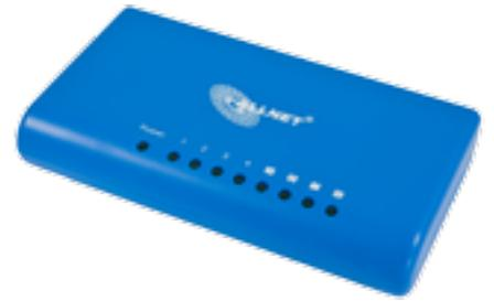
Dieser sehr kompakte Switch ist speziell für den Einsatz im SoHo-Umfeld geeignet. Die acht RJ45 Netzwerk Ports erkennen automatisch die Übertragungsrate der angeschlossenen Geräte (10 oder 100Mbit/s). Durch den Full- und Half-Duplex Betrieb stehen maximal 200 Mbit/s pro Port zu Verfügung.
