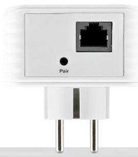
Der ALLNET ALL168603 nutzt den neuesten Qualcomm QCA7450/AR1540 Chipsatz mit Smartlink Technologie. Er verfügt über eine Gigabit Ethernet RJ45 Schnittstelle und ist zu den Powerline Standards IEEE1901/ Homeplug AV und GreenPHY kompatibel. Durch die integrierte Smartlink-Technologie sendet der ALL168603 nicht nur über die Phase sondern auch parallel über die Erde „Grün/Gelben-Kabel“. Diese SmartLink Technologie erhöht die Chance das die Powerlineadapter störungsfreier funktionieren können.
