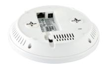
Der ALLNET ALL02860ND ist ein hochleistungs, weitreichender Indoor Dualband 2,4 / 5 GHz Wireless-N Access Point, der über eine hohe Übertragungsleistung (29 dBm auf 2,4 GHz und 5 GHz auf 26 dBm) verfügt. Mit Wireless Geschwindigkeiten von bis zu 300Mbps für jedes Frequenzband und ein Gigabit-Port für den Anschluss an einen Switch oder Router, ist der ALL02860ND ideal für den Ausbau eines Netzwerks mit größerer Bandbreite um weitere Benutzer zu verbinden.
