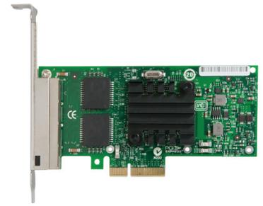
Der Adapter basiert auf dem Intel 82580 Gigabit Ethernet Controller und bietet mit seinen vier Ports eine hohe Flexibilität. Die PCIe Karte der zweiten Generation bietet eine noch bessere Verlustleistung und ist so besonders effizient. Die ALLNET ALL0132-4-GB Karte bietet professionelle Funktionen, wie beispielsweise, Unterstützung von Multi-Core Prozessoren, Server Virtualisierung, sowie ein skalierbares PCI Express Gen2.0 Interface
